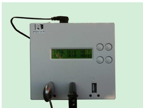
Eenvoudige USB duplicator type UB300 met één Master- en twee Slave-poorten. Met een speciale adapter kan de 'Master' ook een SD-kaart zijn.
